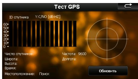
В данном окне представлена информация о вашем местоположении: координаты широты и долготы в градусах, высота над уровнем моря и т.п. В правой части экрана показаны спутники, сигнал от которых принимает устройство, а гистограмма в левой части экрана показывает мощность принимаемого сигнала каждого из спутников.
